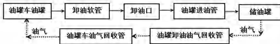
图 2.4-3 汽油卸油工艺流程框图
